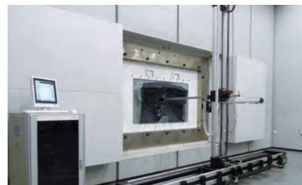
自動車防音材の性能評価システム
