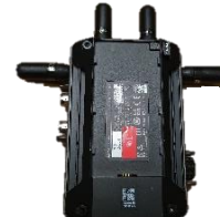
本体送信機 裏 取付ネジ×3 DJIバッテリーアダプター付
